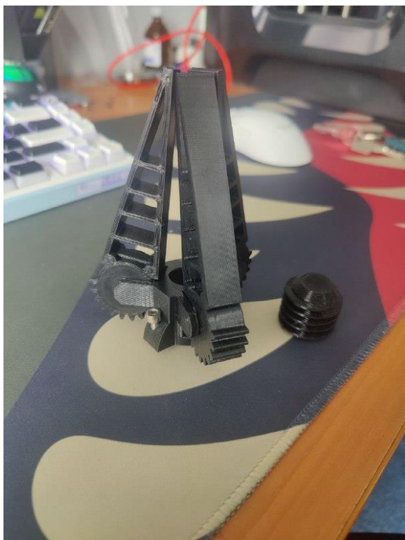
Рисунок 3.9.4 – Реальный мягкий схват в сравнении с прототипом
